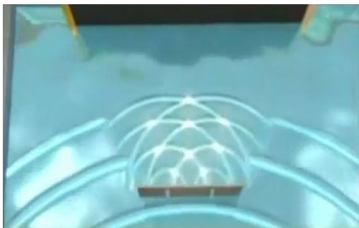
(figura 6) I punti luminosi indicano l'intersezione tra una cresta d'onda e la parte inferiore di un'altra onda: in questi punti le onde si cancellano tra di loro.
